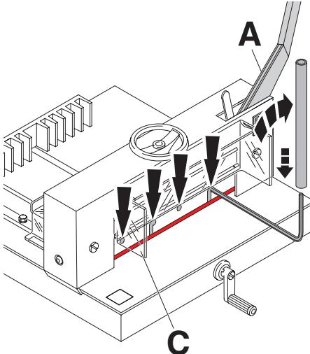
**D** Messerhebel (A) nach oben führen und **arretieren**, Haube vorne (C) nach oben klappen, restliche 4 Messerschrauben festziehen.
