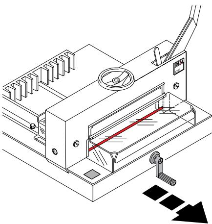
**D** Versehentliche Maßverstellung wird vermieden, durch Vorziehen der Handkurbel.
