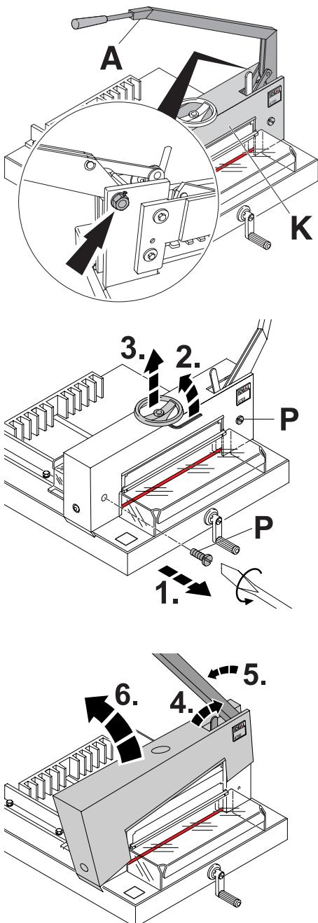
**NL** Het meshandel (**A**) mag nooit uit zichzelf naar beneden vallen. Wanneer nodig de zeskantmoer vastdraaien (verwijder de bovenkap (**K**) verwijder de 2 schroeven (**P**) van de bovenkap (**1.**)
