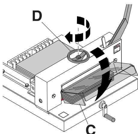
**D** Handrad für Papierpressung (**D**) nach rechts drehen und mit einem kurzen Ruck anziehen. Papierstapel ist fixiert. Haube vorne (**C**) schließen.
