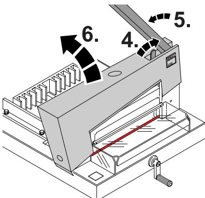
**D** Der Messerhebel (A) darf nicht selbstständig nach unten fallen. Gegebenenfalls Sechskantmutter nachziehen. Abdeckhaube (K) entfernen, die 2 Schrauben (P) der Abdeckhaube herausdrehen (1.). Schraube am Handrad lösen (2.) und Handrad für Pressung abnehmen (3.). Messerarretierung lösen (4.) Messerhebel etwas nach links stellen (5.), dann Abdeckhaube (6.) abnehmen.
