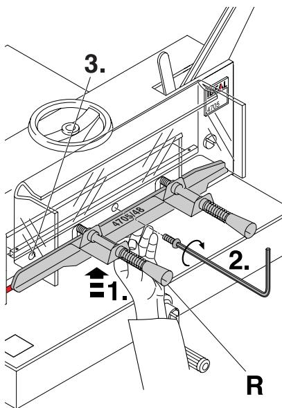
**D** Mit der einen Hand die Messerwechselvorrichtung nach oben drücken (1.).
