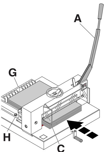
**I** La leva di taglio (**A**) é **arretrata** all punto di partenza, alzare lo schermo di sicurezza (**C**). Posizionare essattamente le pile di carta sul margine posteriore (**G**) e sul margine laterale (**H**).
