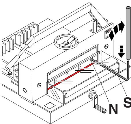
**D** Messerschraube (N) mit Spezialschlüssel (S) und aufgestecktem Verlängerungsrohr festziehen.
