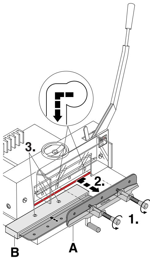
**D Die Griffe der Messerwechselvorrichtung (A) eine Umdrehung nach links drehen (1.). Das Messer mit Messerwechselvorrichtung (A) nach links schieben und nach unten entnehmen (2.). Messer in den dafür vorgesehenen Messerkasten (B) legen und festschrauben (3.).**
