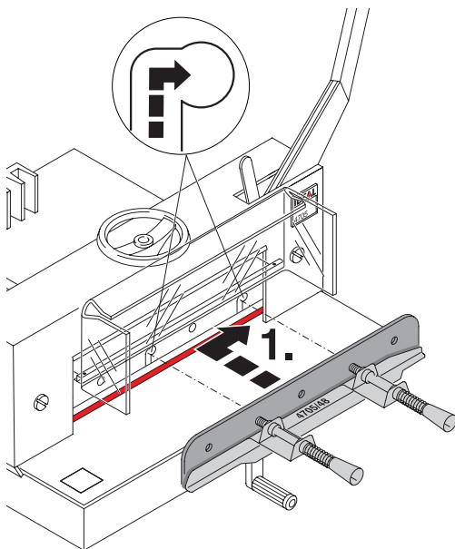
**D** Austauschmesser mit aufgeschraubter Messerwechselvorrichtung ganz nach oben und nach rechts in den Messerträger schieben (1.) (siehe Bild A) dabei die beiden Federn nach hinten drücken. Das Drücken der beiden Federn ist nur nötig, wenn ein nachgeschliffenes Messer eingebaut wird (siehe Bild B).
