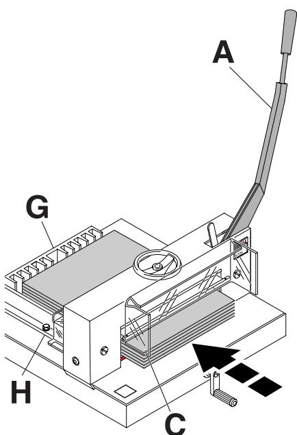
**D** Der Messerhebel (**A**) steht **arretiert** in der oberen Ausgangsposition, Haube vorne (**C**) nach oben klappen, Papierstapel von vorne in die Maschine einschieben und hinten am Rückanschlag (**G**) und links am Seitenanschlag (**H**) exakt anlegen.
